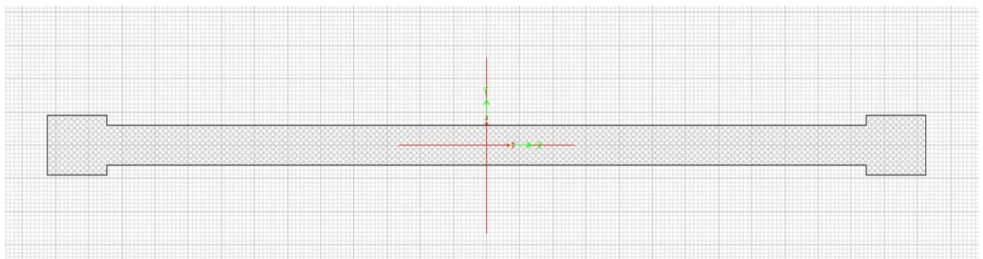
➤ برای آرماتور گذاری دیوار دستور Draw>Draw Reinforcing Shape>Rectangular Pattern را اجرا می کنیم . سپس در سه موقعیت وسط دیوار و ستون چپ و ستون راست مقطع کلیک میکنیم . آرماتورهای نمایشی را باید در دیوارها پخش کنیم . همانند شکل زیر بر روی هر مستطیل آرماتور نمایش داده شده کلیک راست میکنیم و ابعاد آنها را مطابق شکل زیر وارد میکنیم .
